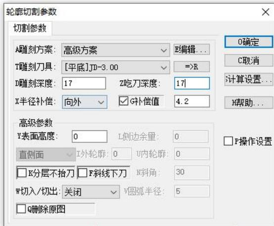
**选择原图**，选择刀具 **平底刀 3 mm** 设定雕刻深度，在补偿值里填入外扩的深度，
