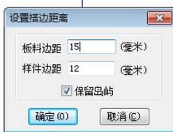
输入板料边距和样件边距的参数——确定，再选择需要往方框内排入的图形，点击增加样件——自动排样——设定好自动排参数——开始排样，排好后——退出环境。
