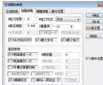
粗雕策略里（雕刻深度多少吃刀深度就改多少）刀的重叠率，改完点击确定。
